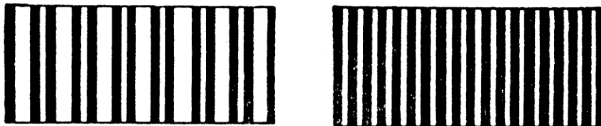
شکل ۶- اشکال حرکت پروانه وقتی زمان سنج ۲۰۰ دور در دقیقه را نشان نمی دهد.
