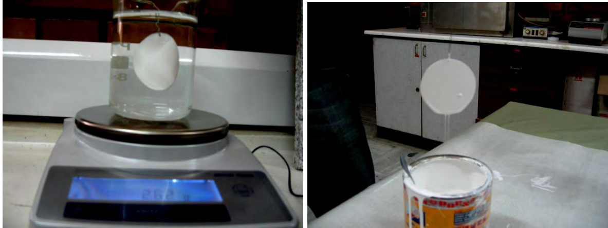
شکل-۱۱ نمایی از مرحله ریزش رنگ از روی نمونه شکل-۱۲ نمایی از نحوه غوطه وری نمونه در آب
